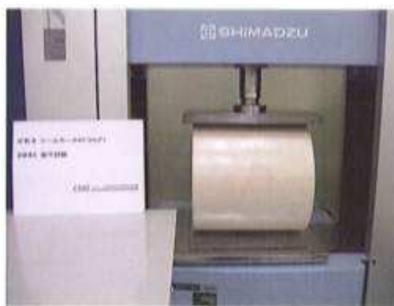
写真 4-7 偏平試験状況
