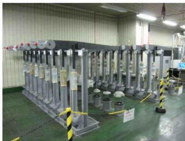
写真 4-13 引張りクリープ試験状況
