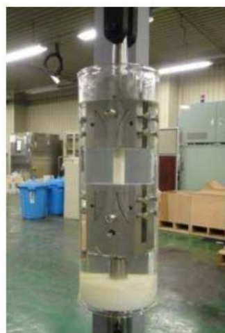
写真 4-13 引張りクリープ試験状況
