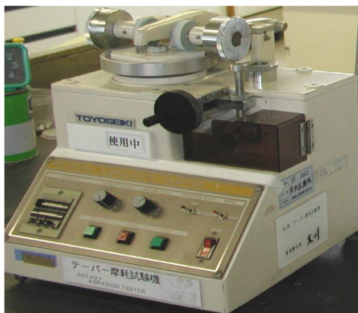
写真 4-8 耐摩耗性試験状況
