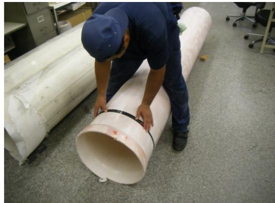
写真21 内径方向寸法確認状況
