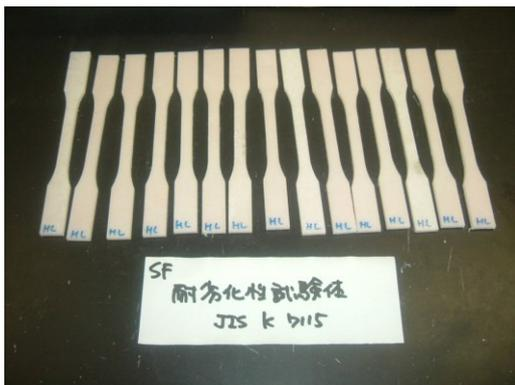
写真8 耐劣化性試験片
