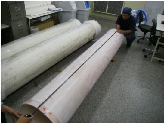
写真20 軸方向寸法確認状況
