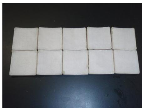
写真5 耐薬品性試験片
