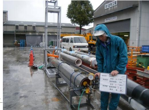
写真 1 1 水圧試験状況
