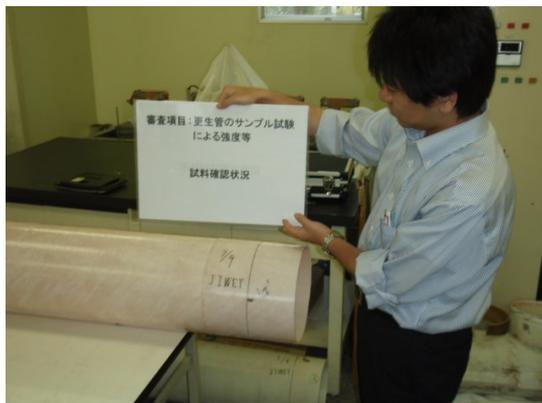
写真2 試験片採取用更生管
