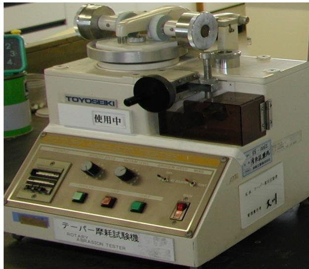
写真 7 耐摩耗性試験状況
