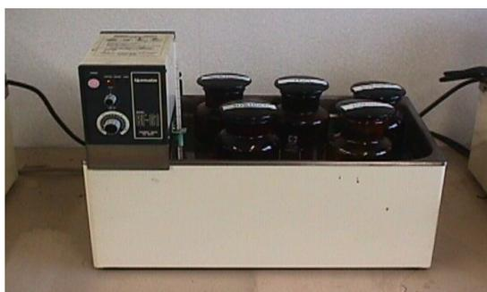
写真6 耐薬品性試験の状況
