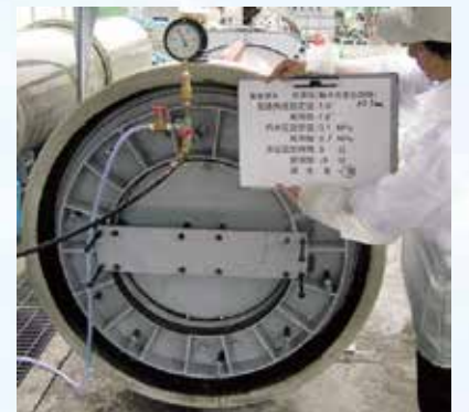
漏水確認状況
